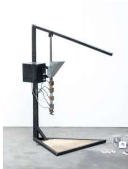
Figura 1: Inyectora de Precious Plastic similar a la desarrollada por MAREA Plastic. Fuente:web One Army.
