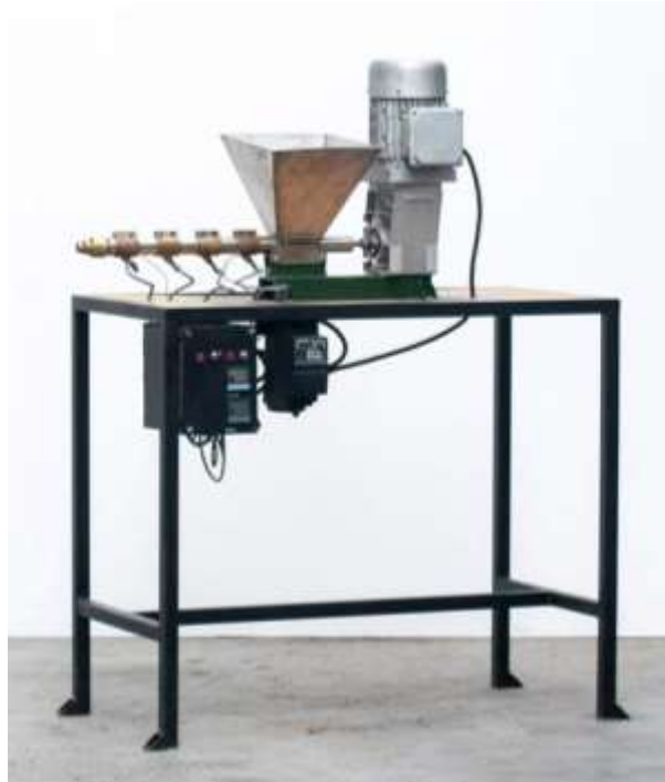
Figura 2: Extrusora de Precious Plastic, similar a la desarrollada por MAREA Plastic. Fuente: web de Precious Plastic
